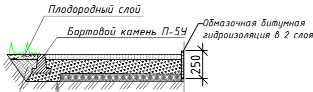
КОНСТРУКЦИЯ ПОКРЫТИЯ ОТМОСТОК Тип IIIб
